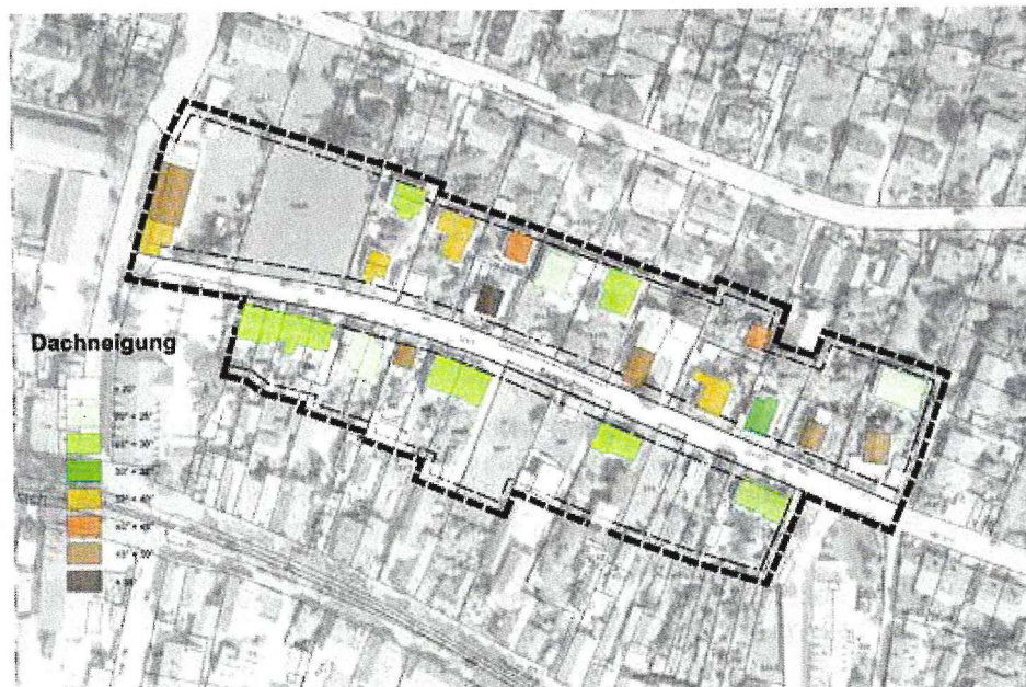
Bestandserhebung – vorhandene Dachneigungen (© AKFU Architekten und Stadtplaner; o.M.)
